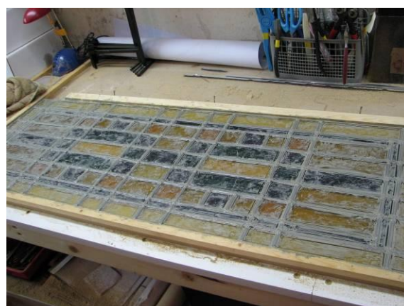
Figuur 12: ook de tweede zijde moet gekit worden (raam komt in de voordeur)
