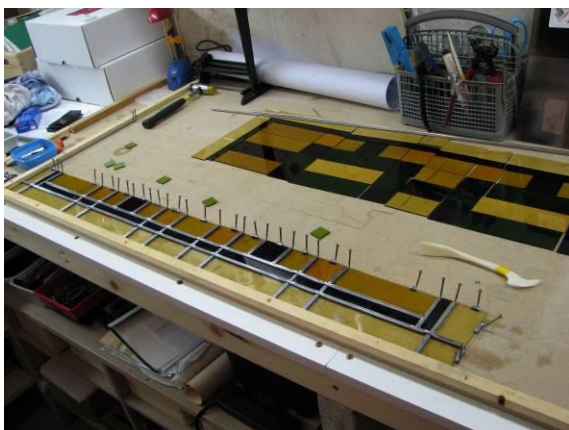
Figuur 5: (extra glas gesneden en) in lood zetten
